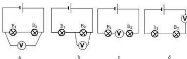
Circuito a: el voltímetro mide el voltaje entre los extremos de las dos bombillas y no de B<sub>2</sub> como se pretende.
