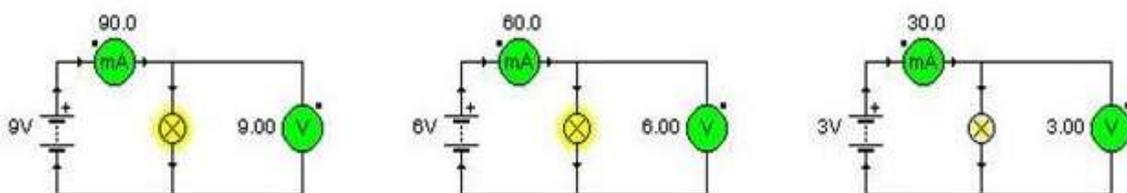
En los tres circuitos el amperímetro mide la intensidad de corriente (expresada en miliamperios) que circula por la bombilla, y el voltímetro el voltaje entre sus extremos (que coincide con el de la pila en los tres casos).
