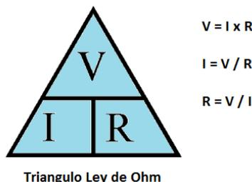
Imagen nº 25. Triángulo de Ohm Fuente: Wikimedia
