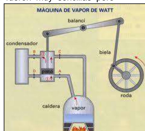
Imagen 4: Máquina de vapor de James Watt Fuente: tecnologias.us . Autor: Desconocido. Licencia: Desconocida
